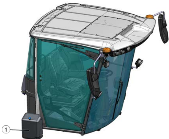
Fig. 163: Réservoir du liquide lave-glace
