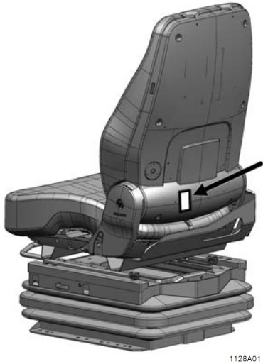
Fig. 23: La position de la plaque d'identification du siège de conduite
