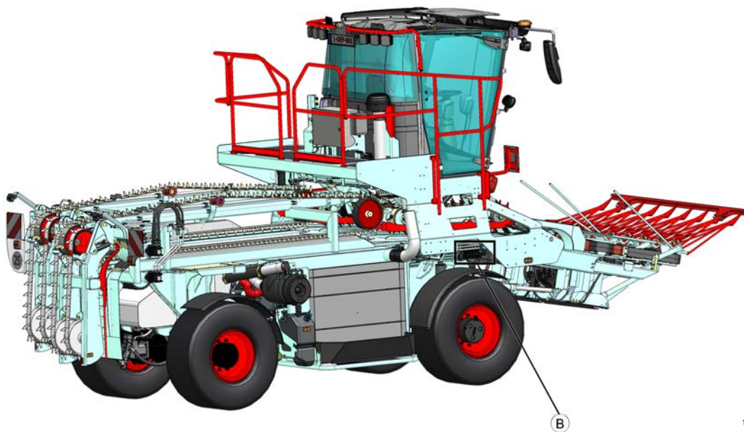
Fig. 78: Localisation des leviers de commande manuelle en bas (B)
