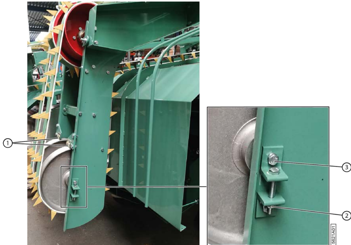
Fig. 210: Régler la tension des courroies déposées
