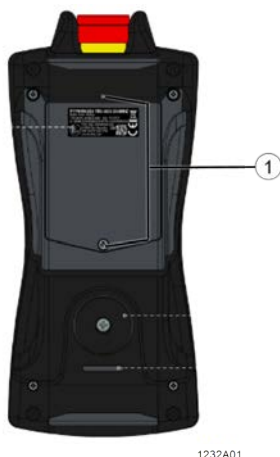
Fig. 141: Remplacer les batteries de la télécommande
