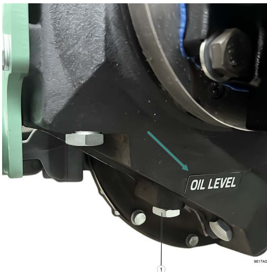
Fig. 149: L'indication du niveau d'huile sur un réducteur TWIN DISC.
