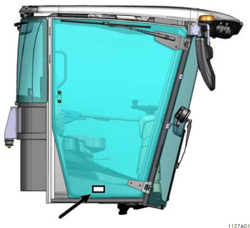
Fig. 21: Localisation de la plaque d'identification de la cabine
