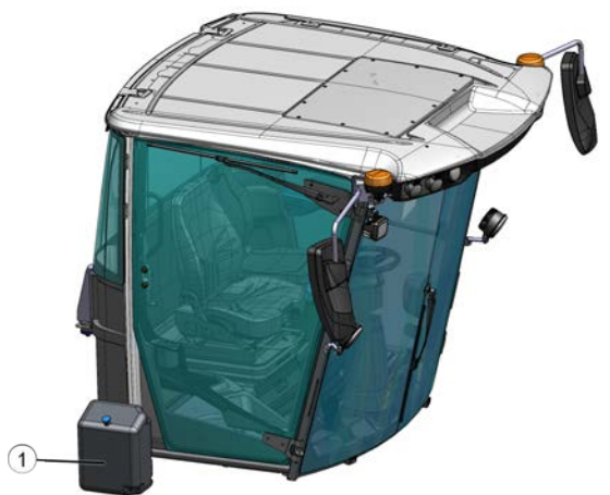
Fig. 31: Réservoir du liquide lave-glace
