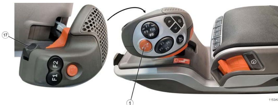
Fig. 137: Réduire ou augmenter la vitesse des courroies d'arracheur
