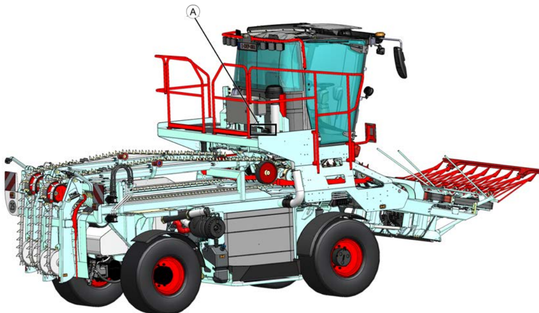
Fig. 76: Localisation des leviers de commande manuelle en haut (A)
