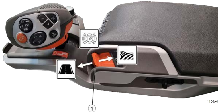
Fig. 133: Mettre le bouton en mode Sur place
