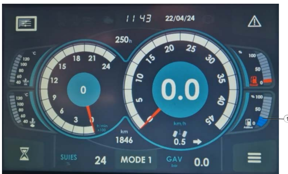
Fig. 144: Affichage du niveau d'AdBlue sur la fenêtre du mode Route
