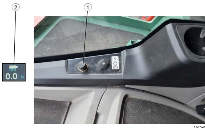
Fig. 208: Régler la pression des rouleaux écraseurs
