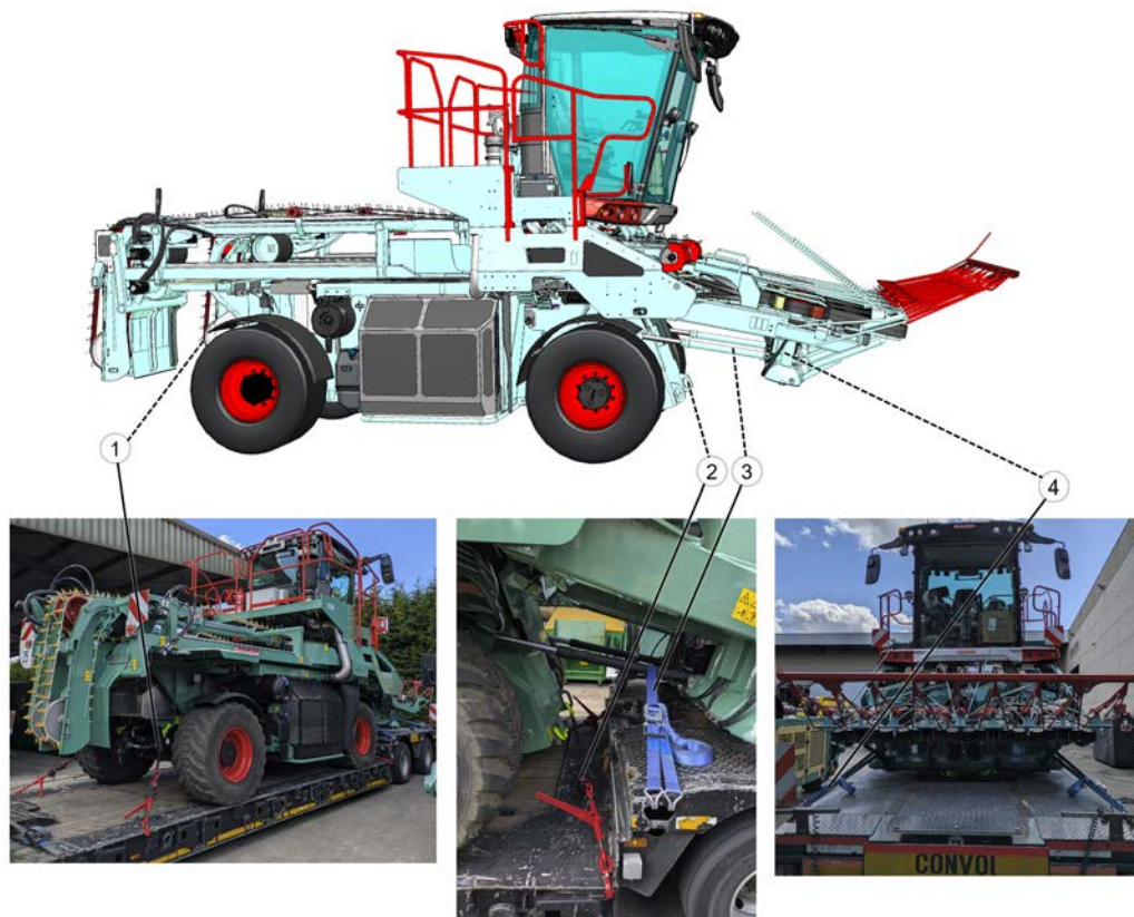
Fig. 71: Charger la machine sur le camion
