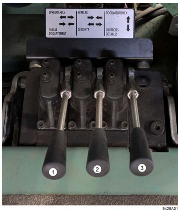
Fig. 77: Aperçu des fonctions des leviers de commande manuelle
